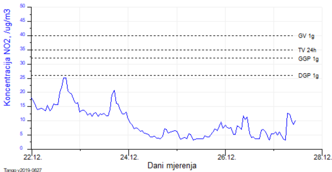
Grafički prikaz 4-21: Grafički prikaz usrednjenih imisijskih 60 – minutnih koncentracija NO 2 na lokaciji Luka Bršica, Lokacija 1, za razdoblje mjerenja 22.12. – 27.12.2022.
