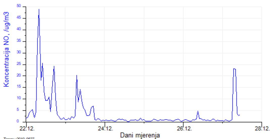
Grafički prikaz 4-18: Grafički prikaz usrednjenih imisijskih 60 – minutnih koncentracija NO na lokaciji Luka Bršica, Lokacija 1, za razdoblje mjerenja 22.12. – 27.12.2022.
